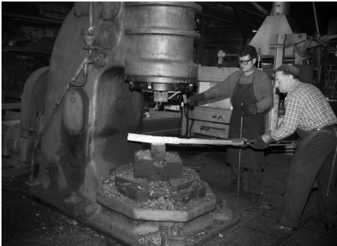
Robert Schweitzer et Rodolphe Reimmel travaillent au marteau« Bêché ». Robert maintient à l'aide de tenailles la tige carrée de 60mm/60mm pour réaliser le préforme ou l'ébauche. Rodolphe tient le levier de commande pour dégager l'orifice qui conduit la vapeur de la chaudière sous le piston.
