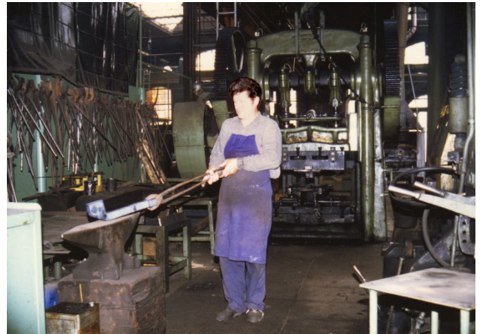
Rodolphe Reimmel à la forge, derrière lui l'ébarbeuse.
