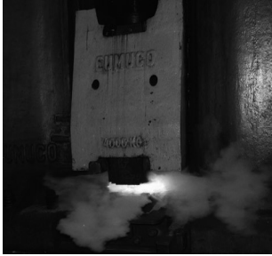
Mouton de l'« Eumuco » Sa masse est de 3 tonnes.
