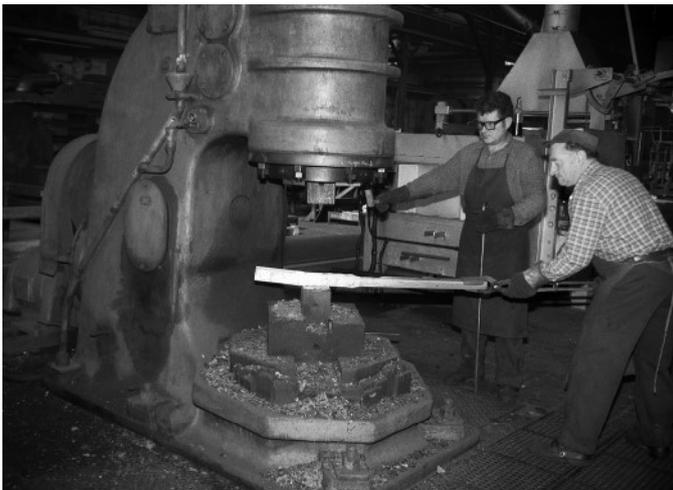
*Robert Schweitzer et Rodolphe Reimmel travaillent au marteau« Bêché ». Robert maintient à l'aide de tenailles la tige carrée de 60mm/60mm pour réaliser la préforme ou l'ébauche. Rodolphe tient le levier de commande pour dégager l'orifice qui conduit la vapeur de la chaudière sous le piston.*
