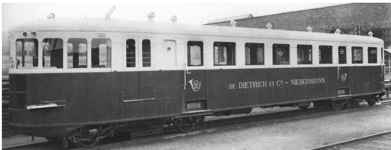
**Le prototype de l'automotrice 210 ch**
